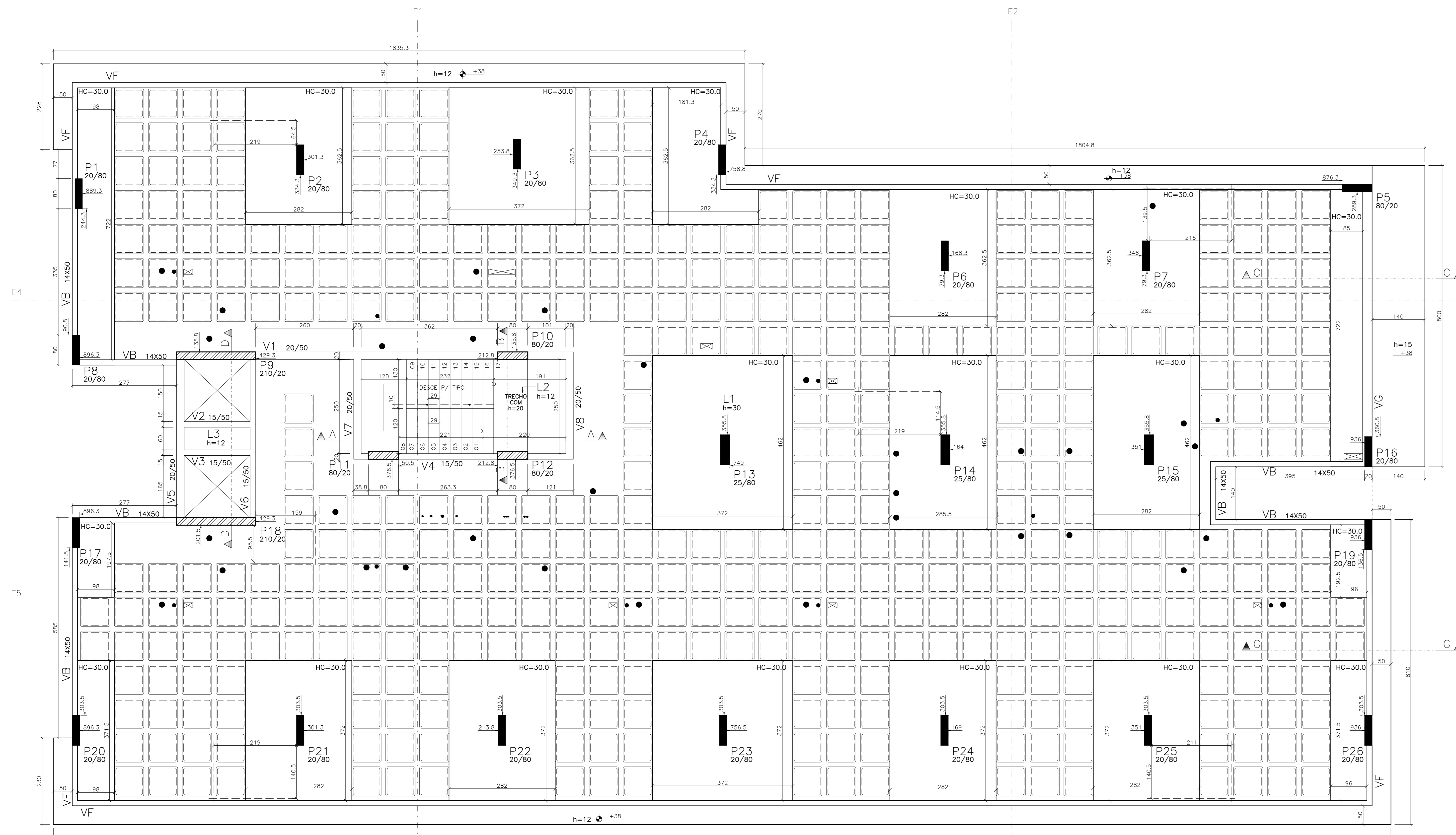
PAVIMENTO TELHADO PLANTA DE FORMAS ESCALA: 1/50
